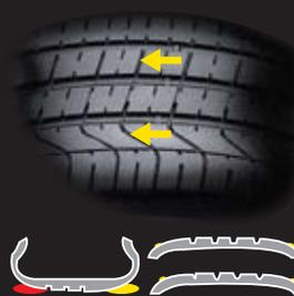
Para compensar la deformación dinámica el diseño de banda de rodamiento es diferente, entre el lado izquierdo y derecho debido a las diferentes masas generadas durante el efecto centrífugo.
